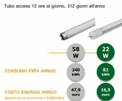
Figura 8.7 – Esempio comparativo lampade neon e LED
