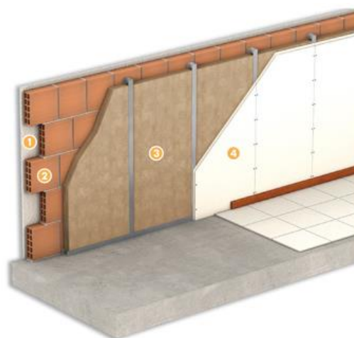
Figura 8.3 – Particolare composizione cappotto interno
